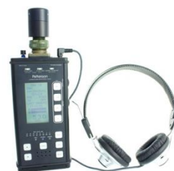
Détecteur à ultrasons utilisé pour certaines espèces peu audibles voire inaudibles.
