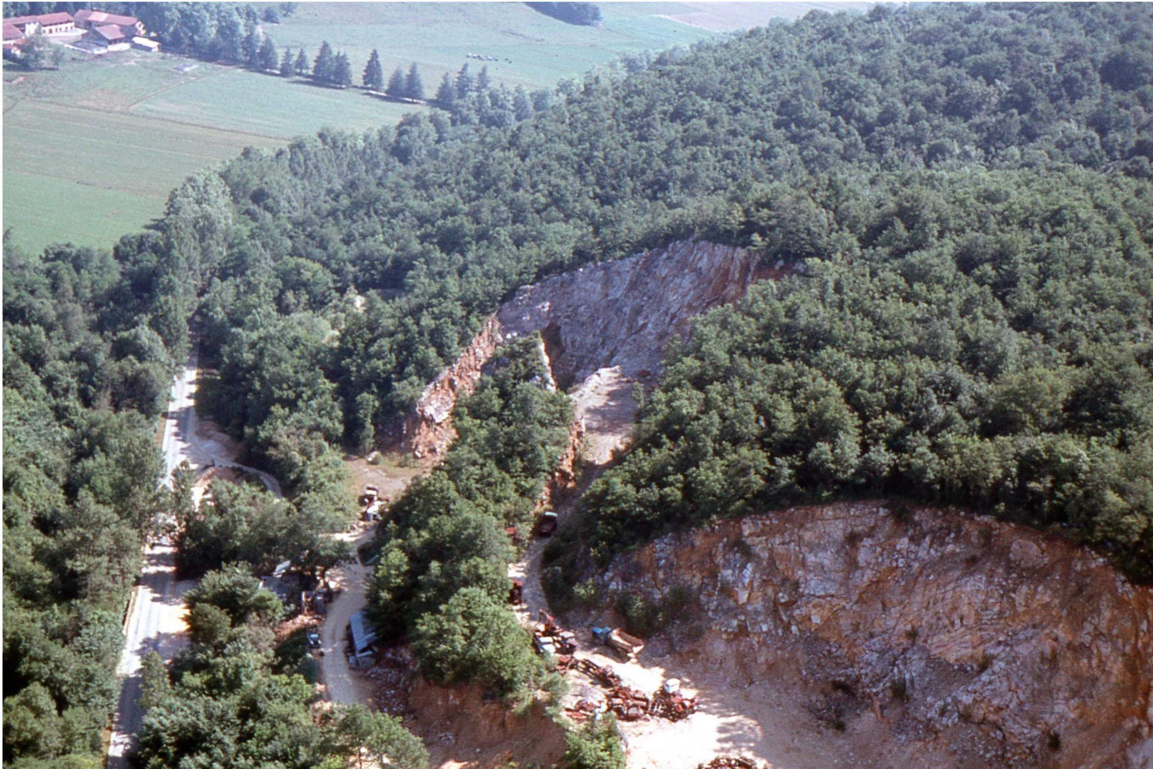
**Le site de Coupe-Gorge– exploitation de calcaire de 15.000 t/an – Exploitation jusqu'en 2007 – Montmaurin**
