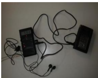
Figure 41 : Détecteur D240X couplé à son enregistreur Edirol R-09HR
