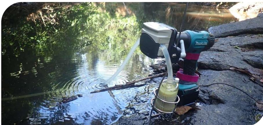
Figure 73: Appareillage filtrant l'eau pour le prélèvement d'ADNe
