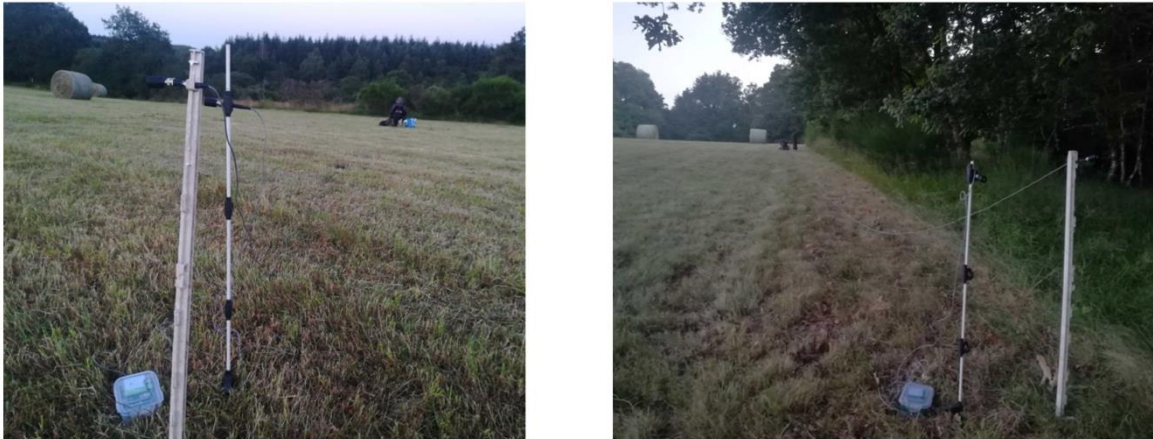
Figure 73. Stations d'écoute (centre de prairie à gauche, lisière à droite) de comparaison actif vs passif sur la prairie de L'Épine (Lachaud). Les deux microphones, au sommet de piquets, sont reliés pour l'un à l'enregistreur automatique PassiveRecorder en fonction toute la nuit, et pour l'autre au détecteur manuel ActiveRecorder manipulé par l'observateur (distant de 20 mètres pour ne pas générer de bruits parasites) durant les 3 premières heures de la nuit.
