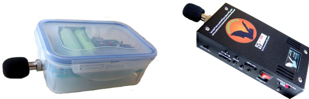
Figure 72. Teensy Recorders développés par Jean-Do Vrignault. A gauche : l'enregistreur automatique Passive Recorder ; à droite : le détecteur manuel Active Recorder.
