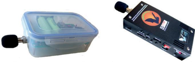
Teensy Recorders développés par JD Vrignault. A gauche : l'enregistreur automatique Passive Recorder ; à droite : le détecteur manuel Active Recorder
