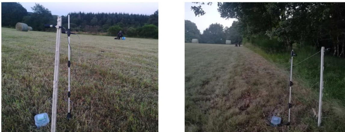
Figure 10. Stations d'écoute (centre de prairie à gauche, lisière à droite) de comparaison actif vs passif sur la prairie de L'Epine (Lachaud). Les deux microphones, au sommet de piquets, sont reliés pour l'un à l'enregistreur automatique PassiveRecorder en fonction toute la nuit, et pour l'autre au détecteur manuel ActiveRecorder manipulé par l'observateur (distant de 20 mètres pour ne pas générer de bruits parasites) durant les 3 premières heures de la nuit.
