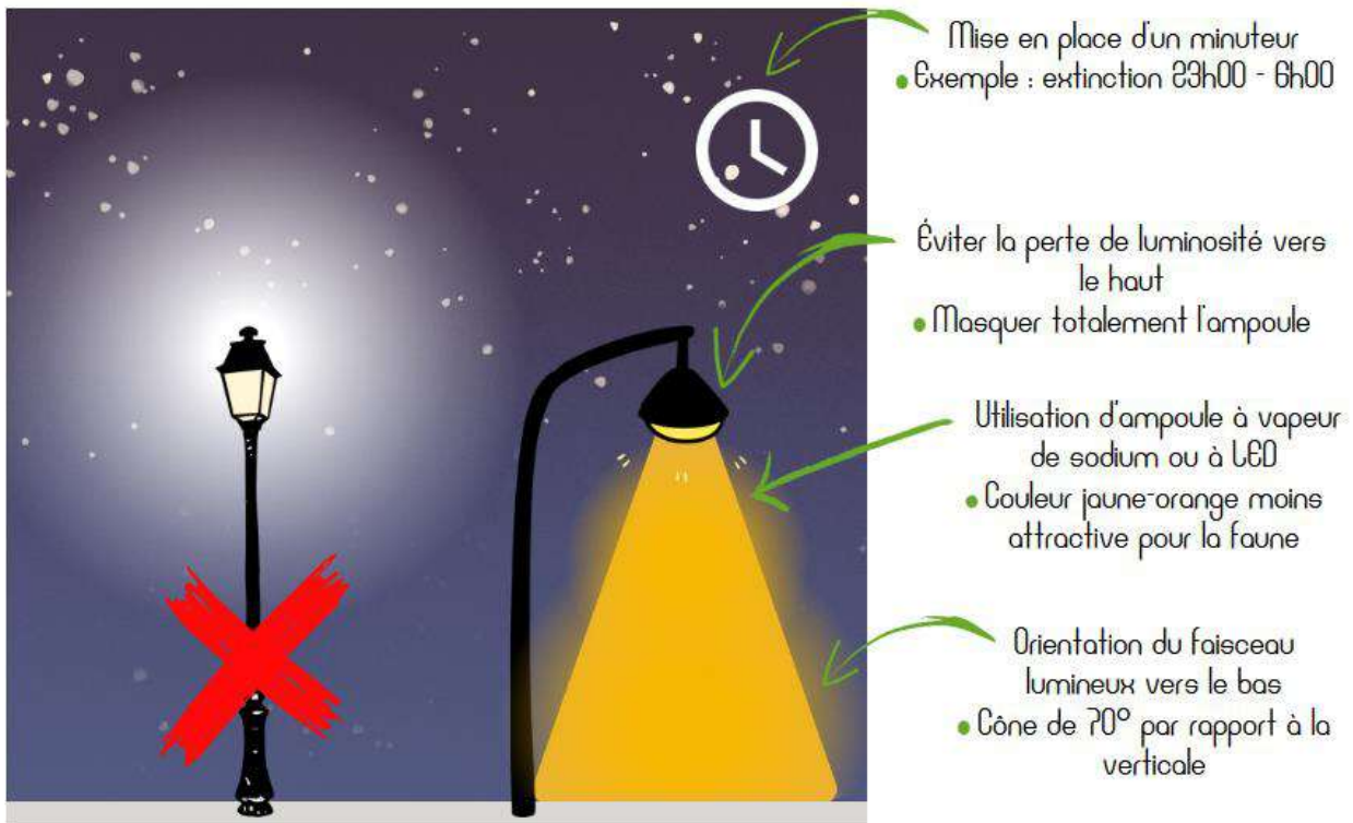
Figure 45 : Schéma d'un éclairage public adapté pour réduire son impact sur la pollution lumineuse (© ReNARD)
