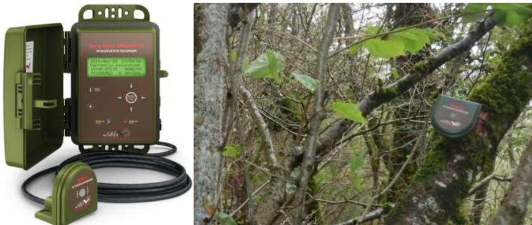
Figure 2. Enregistreur automatique SM4Bat+© et micro en place © P. Hureau
