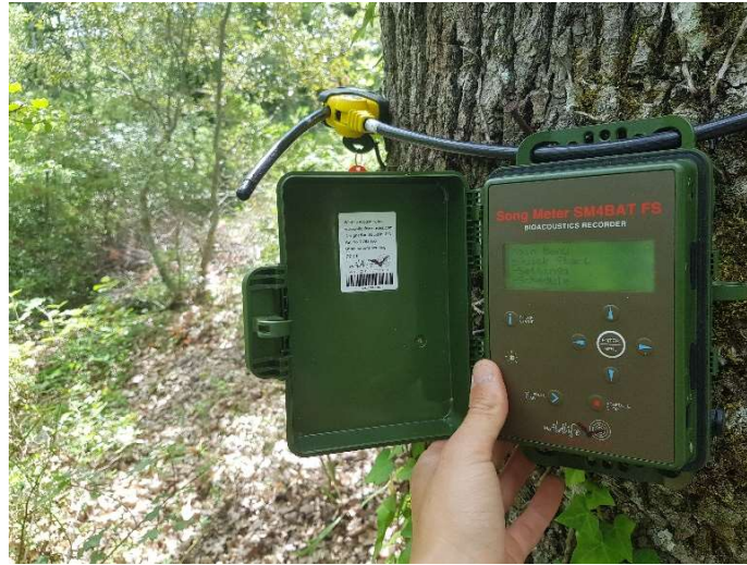
Figure 9. Paramétrage d'un SM4BAT © J. COSTA | CEN PACA
