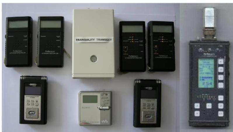
Photo 2 : Détecteurs-amplificateurs d'ultrasons et enregistreurs numériques utilisés lors de l'étude
