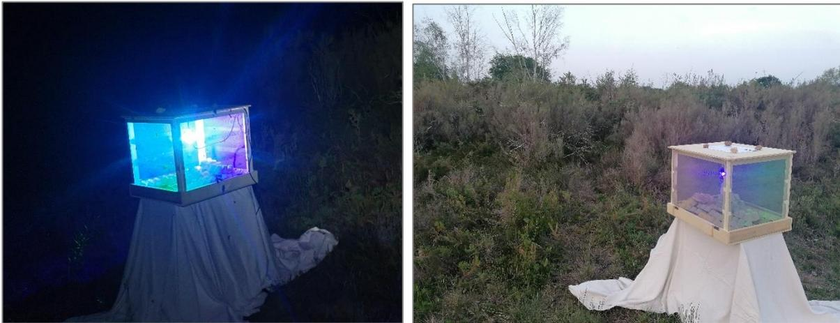
Comme les insectes nocturnes réagissent particulièrement bien à la lumière ultraviolette, quatre des LED haute performance émettent à 365 nm. Ce nouveau dispositif est très peu intrusif, il fonctionne avec une batterie externe, il ne fait donc pas appel à un générateur (bruyant) et n'émet pas une lumière aveuglante.
