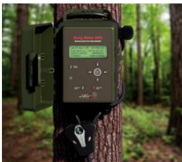
Figure 1 : Un enregistreur SM4 Bat déployé sur un arbre ( Wildlife acoustics )
