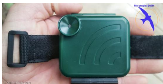
Présentation d'un AudioMoth dans son coffret étanche IXP7
